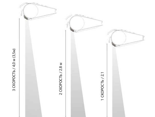
РИС. 2.2 ДЛИНА ПОТОКА ВОЗДУХА НА КАЖДОЙ СКОРОСТИ.
